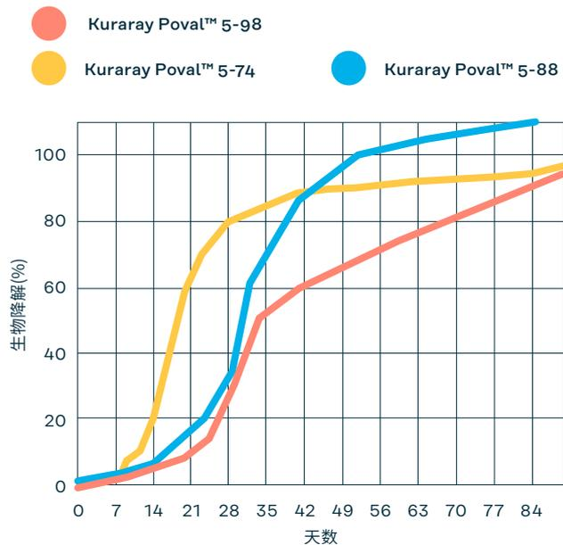
按照ISO14851标准, 可乐丽产品在水中的内部水生物降解测试结果见图1。PVOH的生物降解率接近100%。可观察到在生物降解开始之前, 有一定的诱导期, 可以理解为微生物在这段时间内逐渐生长。
