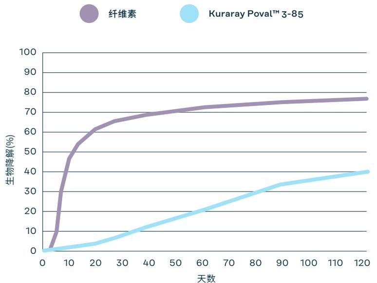
根据ISO 17556标准, 可乐丽在土壤中的外部生物降解测试结果见图2。122天后, 可乐丽Poval™ 3-85的生物降解进一步进行, 测得的绝对生物降解率为39.2%。从测试结果来看, 我们可以说可乐丽Poval™本身就是一种 溶解于水时可被生物降解
